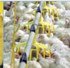
HaiKoo™ Sistema de alimentación con platos de forma ovalada para pollos de engorde.
